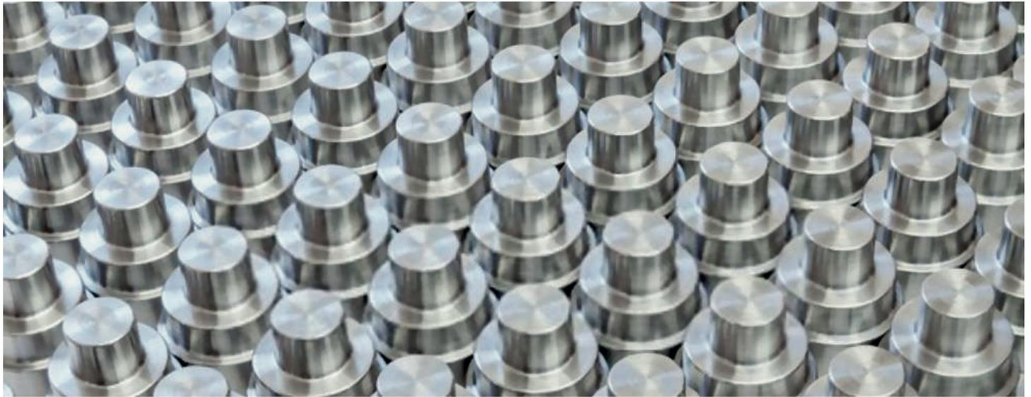
Automatenstahlqualität mit einer mit Vergütungsqualitäten vergleichbaren Zugfestigkeit
