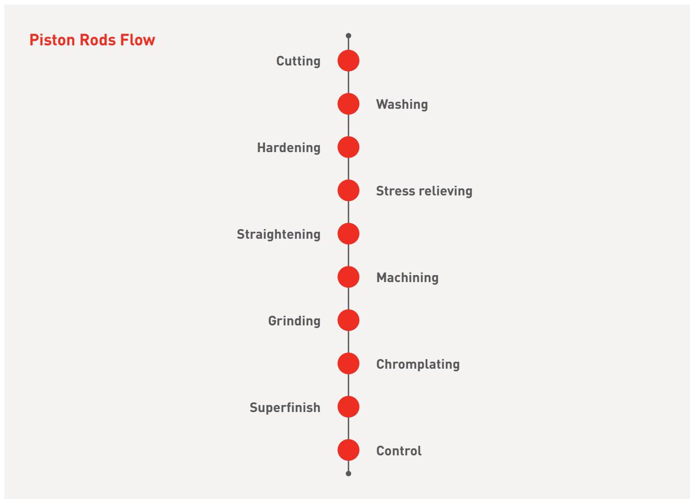
El material utilizado para la fabricación habitual de este componente es un SAE1040 estirado o estirado + torneado en diámetros en la gama de entre 15 y 30 mm y que debe garantizar un nivel de límite elástico mínimo en el entorno de los 600 MPa.
