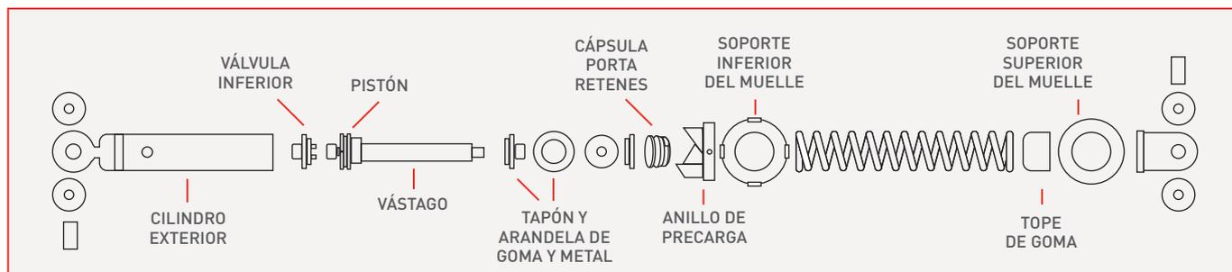
Los amortiguadores de un turismo convencional están formados por diferentes piezas de las cuales el vástago es una parte muy importante en su funcionamiento. Se trata de una pieza cilíndrica cortada a medida y cromada que proviene de barras de acero especial con garantía de características mecánicas y con gran calidad superficial que facilite su cromado posterior.
