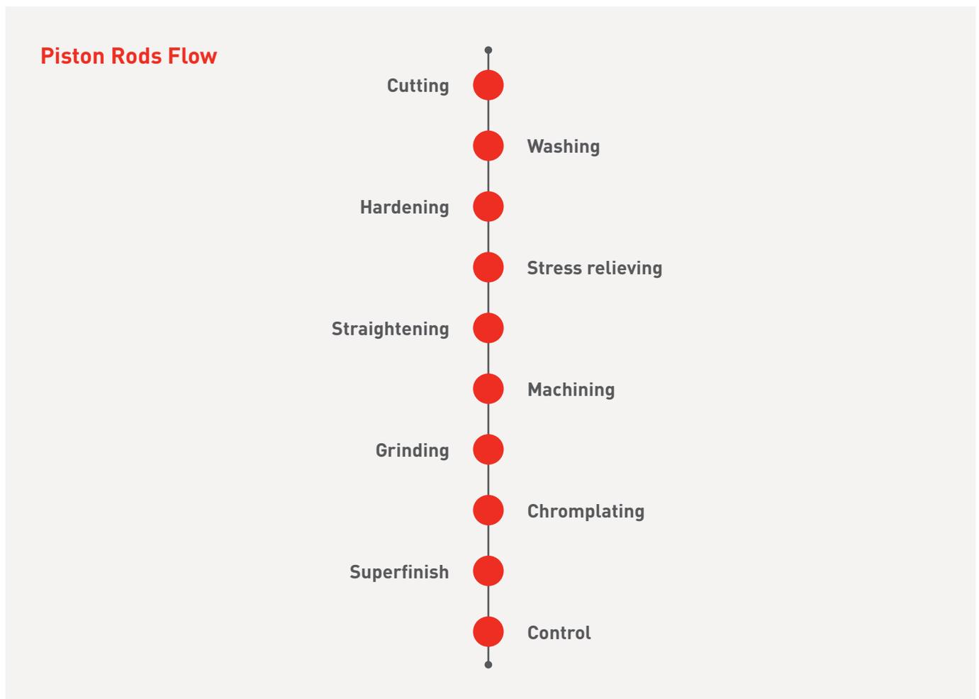
Der zur Herstellung dieses Bestandteils verwendete Werkstoff ist ein gezogener oder gedrehter SAE1040 mit Durchmessern von 15 bis 30 mm, der eine minimale Mindestelastizität um 600 MPa gewährleisten soll.
