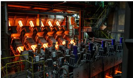
Continua actualización de **instalaciones** de fabricación: reciente **inversión en la máquina de colada continua de palanquilla de 240x240 mm** dotada de las últimas tecnologías de control.
