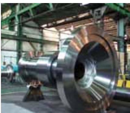
Hydro generator shaft ( $\varnothing$  2400 mm)
